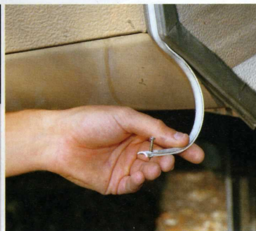
2 Herausziehen: Die Dichtbänder sind am jeweiligen Ende mit Schrauben gesichert.
