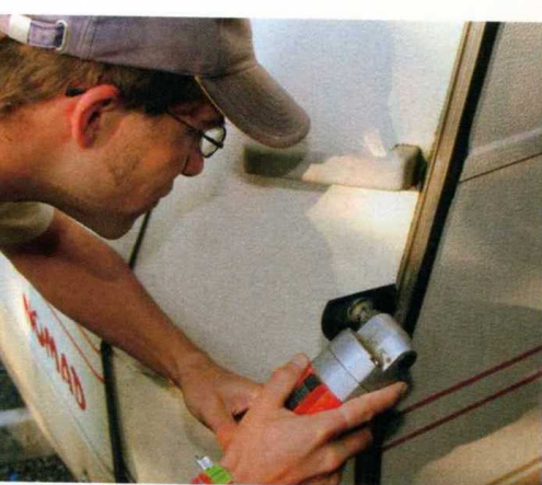
3 Murks ab Werk: In die vernickelten Schraubenköpfe wird ein Schlitz gesägt.
