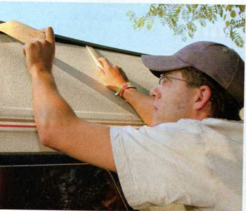
6 Ohne Gewalt: Die heiße Kantenleiste wird mit zwei Keilen von der Seitenwand abgedrückt.
