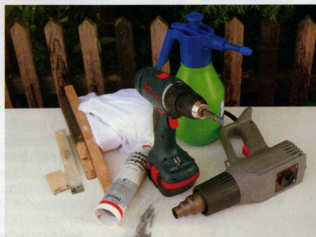
1 Ohne geht's nicht: Keile, Putzlappen, Dichtmasse, Akkuschrauber, Silikonentferner in der Pumpflasche, Heißluftfön.
